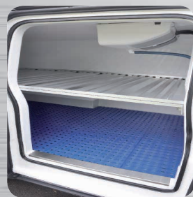
Isolation des ouvrants d'origine par des contre-portes isothermes
