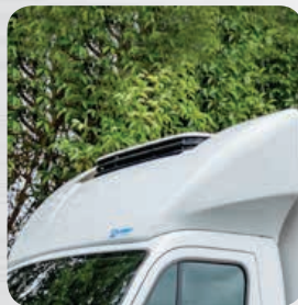
Déflecteur aérodynamique avec découpe tridimensionnelle pour groupe
