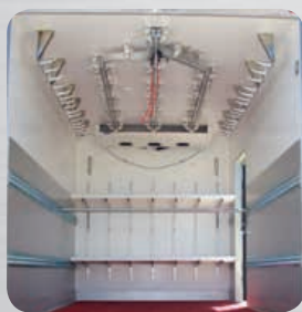
Réseau aérien Barres à viandes Protection aluminium
