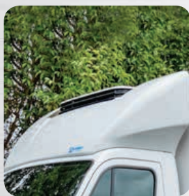
Déflecteur aérodynamique avec découpe tridimensionnelle pour groupe
